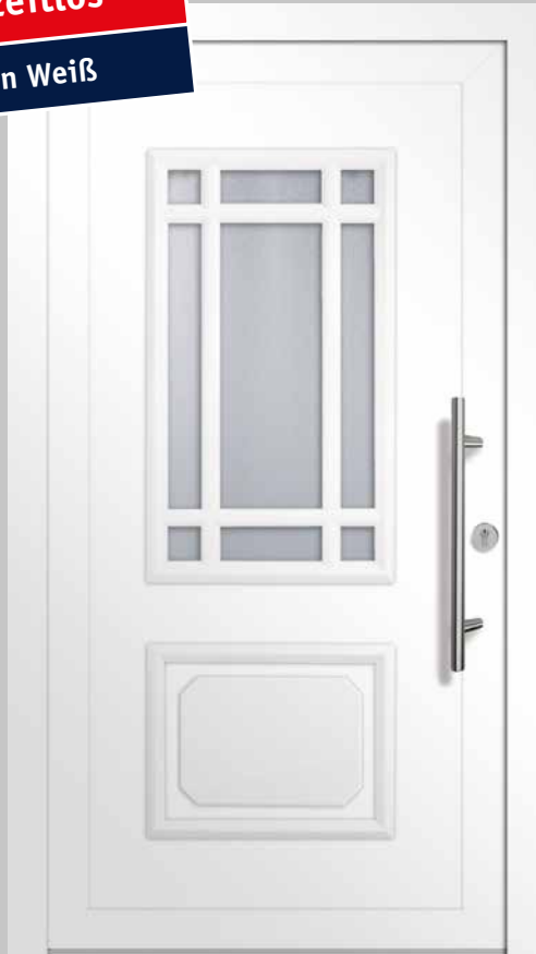
Typ A81908 | Einsatzfüllung | Verkehrsweiß RAL 9016 | Stangengriff S 1020, 600 mm | Edelstahl-Rundrosette | Ornamentglas Chinchilla | Lichtausschnitt 516 mm x 944 mm
